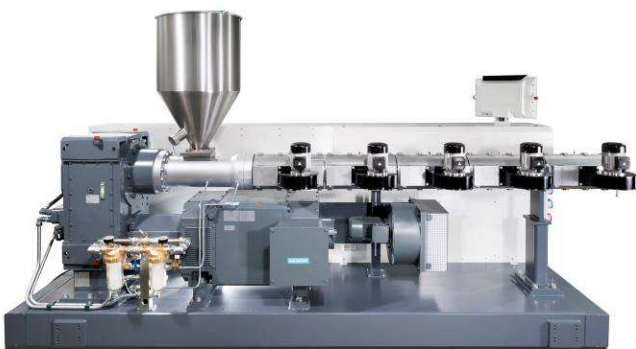
soLEX NG: extrusão de tubos de PO de alto desempenho de microdutos a grandes diâmetros, tubos de parede fina com até 2,6 m
