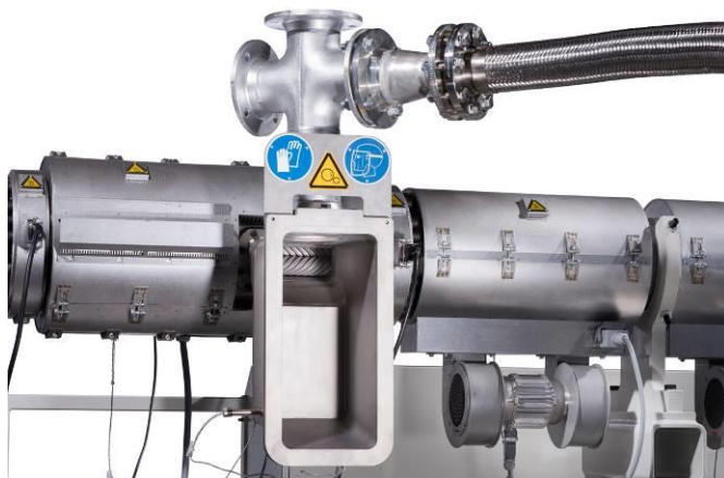
Visão de perto da zona de desgaseificação planetária que garante a desgaseificação altamente eficiente da massa fundida
