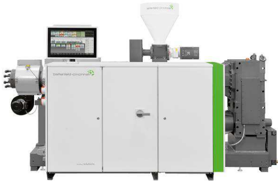
conEX NG 65: Flexible, Energie sparende Verarbeitung von PVC mit der neuen BCTouch UX Steuerung
