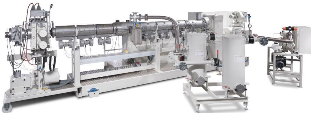
STARextruder: Effiziente Entgasung für die direkte Verarbeitung von PET
