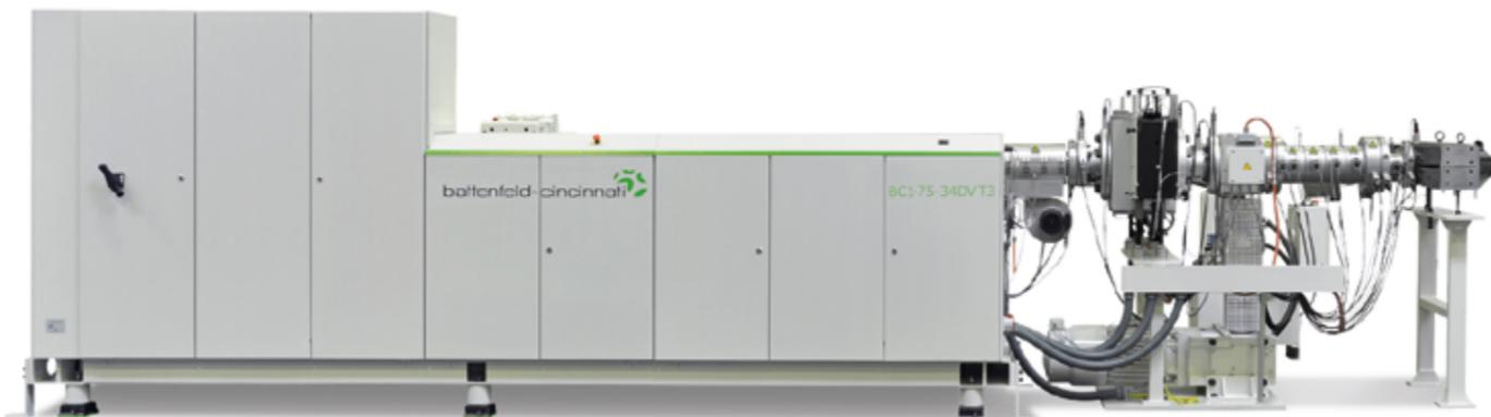
Oben Frontansicht bcHighspeed Extruder und rechts Seitenansicht vertikaler Rollstack
